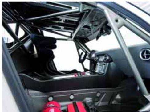
mayor rigidez al chasis de aluminio. Pero si hay algo que realmente llama la atención a cualquier amante del motor es el asiento tipo bacquet con cinturón de seguridad de 6 puntos de anclaje y Hans -pieza que los pilotos se ponen en el cuello, sobre la que descansa el casco y que evita movimientos secos e involuntarios-.
